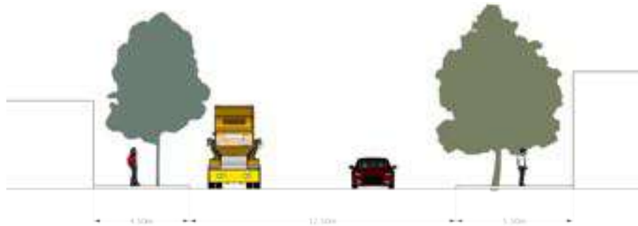
Imagen 60. Sección transversal Calle Norte 59 - vialidad secundaria
